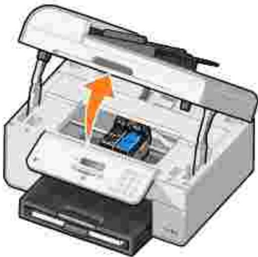
Il supporto delle cartucce di inchiostro si sposta e si arresta nella posizione di caricamento, a meno che la stampante non sia occupata.
